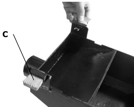
Nastavte tloušťkovací stůl do nejnižší polohy **B**. Vytáhněte plastikové spony **C** ven. Umístěte hubici do spodní polohy na stůl a zamáčkněte spony **C** do příslušných vyfrézování **A** na srovnávacím stole.
