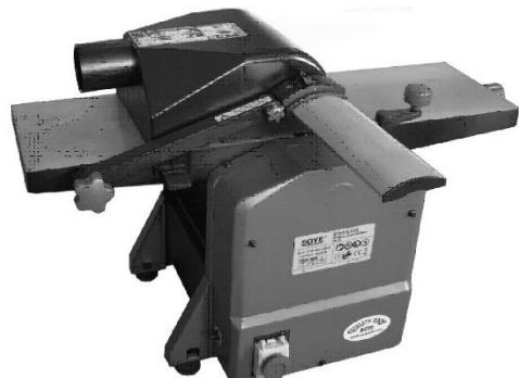
Odsávací hubice se ke stroji připevňuje pomocí dvou spon, kterými se připevní na srovnávací stůl. Při srovnávání hubici připevněte pod stůl, aby hoblinky mohly být spodem odsávány. Při tloušťkování odmontujte kryt válce a nasadte hubici do připravených vyfrézování ve stole.
