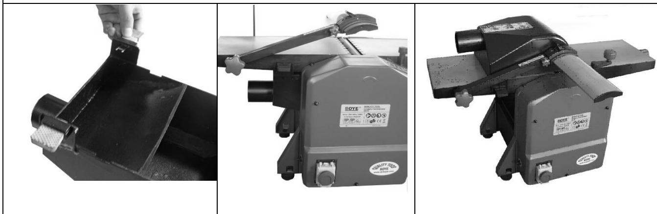
La hotte comporte deux brides qui peuvent être fixés à la table. Pour le dégauchissement, installer la hotte sous la table, de sorte que les copeaux sont absorbés par le dessous. Pour le rabotage enlever la protection de la tête de coupe et puis placer la hotte dans le creux de la raboteuse et la fixer avec la bride dans la fente correspondante.
