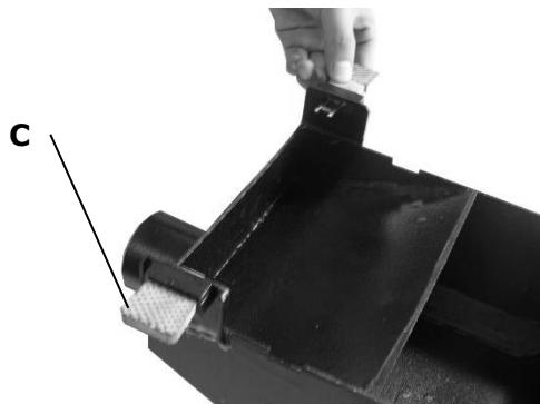
Baje la mesa del regreso **B** a su posición más baja. Tire de las pestañas de plástico **C** del adaptador de la campana hacia fuera. Ahora coloque la campana y apriete las pestañas **C** en las ranuras correspondientes **A** en la mesa de salida del cepillo.
