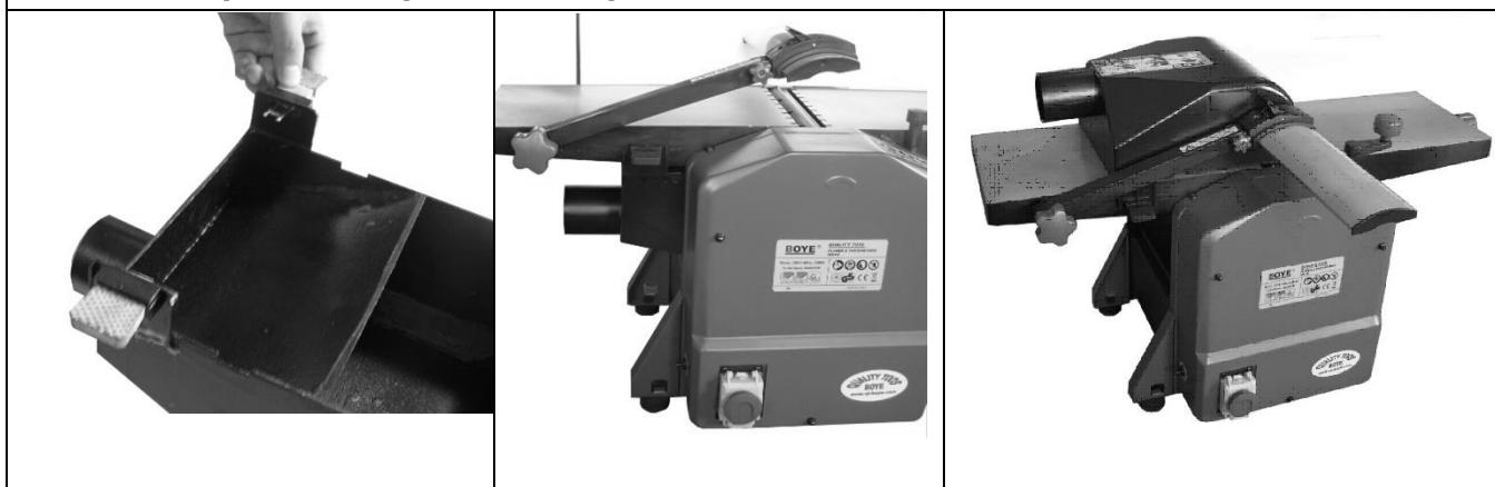
La campana de aspiración tiene dos bridas con las cuales se puede unir a la mesa. Para el cepillado, instale la campana debajo de la mesa, para que las virutas sean absorbidas desde abajo. Para el regreso, quitar la protección del cabezal de corte y colocar después la campana en el hueco del regreso y fijarlo con la brida de nuevo en la hendidura correspondiente.
