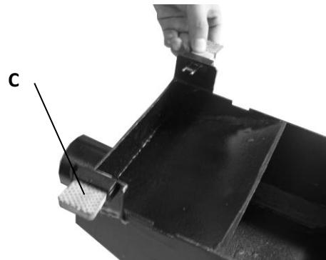
Abaissez la table de raboteuse **B** à sa position la plus basse. Tirez des onglets de plastique **C** de l'adaptateur de la hotte vers l'extérieur. Maintenant, placez la hotte et appuyez les onglets **C** dans les rainures **A** en la table de sortie de la dégauchisseuse.
