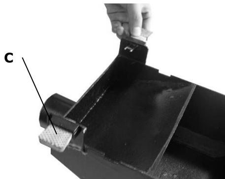
U tu svrhu stol blanjalice **B** spustite u najniži položaj. Sada plastične spojnice **C** odsisnog adaptéra povucite prema van. Pozicionirajte odsisni adapter i utisnite spojnice **C** u za to pre-viđene utore **A** na izlaznom stolu za ravnanje.
