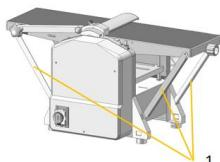
Die vier zum Transport angebrachten Streben vor Gebrauch der Maschine demontieren.
