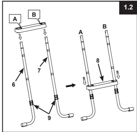
**WICHTIG:** Versichern Sie sich, dass die J-förmigen FüÙe nach auÙen schauen, bevor Sie die Stufen montieren.
