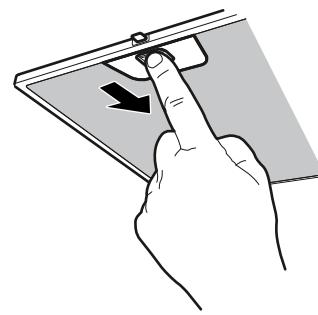
2. Metallfettfilter aus der Halterung herausnehmen.
