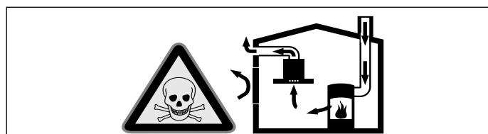
Raumlufthaftige Feuerstätten (z.B. gas-, öl-, holz- oder kohlebetriebene Heizgeräte, Durchlauferhitzer, Warmwasserbereiter) beziehen Verbrennungsluft aus dem Aufstellraum und führen die Abgase durch eine Abgasanlage (z.B. Kamin) ins Freie.
