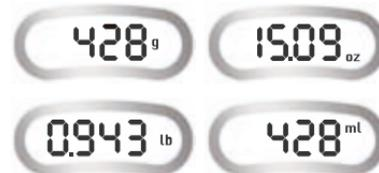
Betätigen Sie die Taste für 3 Sekunden kontinuierlich, um die Einheiten der Reihe nach umzurechnen (g/ounce/lb/ml).
