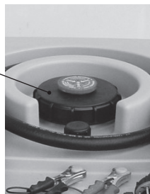
Foto 5.4.2: apertura di riempimento serbatoio da 460l / 600l
