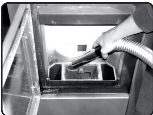
Abb. 14d: Reinigung der Topfhalterung
