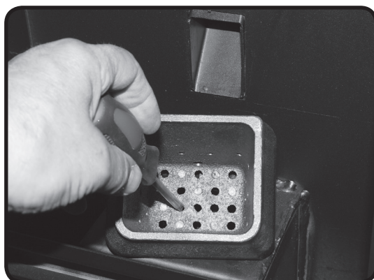
Abb. 14c: Reinigung der Luftöffnungen mit einem Werkzeug
