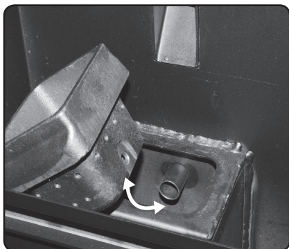
Abb. 7a: Brenntopf einsetzen
