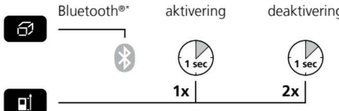
Bluetooth®\*-symbolet dukker opp i displayet etter aktivering (g). Når funksjonen er aktivert, kan et mobilt sluttapparat kople seg til måleinstrumentet vha. en app.
