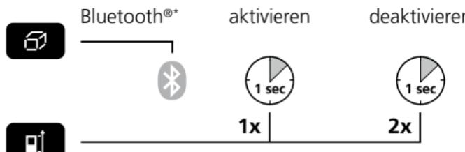
Das Bluetooth®\*-Symbol erscheint nach Aktivierung im Display (g). Bei aktiver Funktion kann sich ein mobiles Endgerät mittels einer App mit dem Messgerät verbinden.
