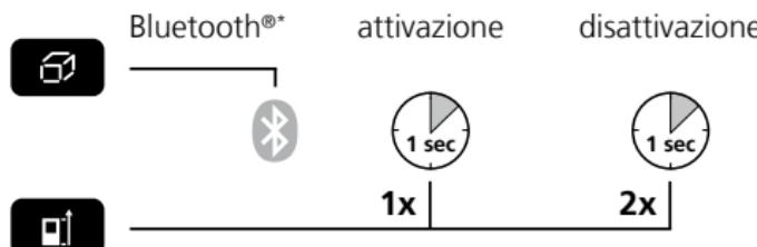
Dopo l'attivazione, il simbolo Bluetooth®\* appare sul display (g). Attivando la funzione, un terminale mobile può connettersi con l'apparecchio di misurazione per mezzo di un'app.
