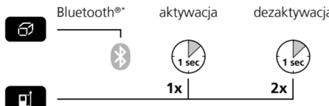
Symbol Bluetooth® ukazuje się po aktywacji na wyświetlaczu (g). Przy aktywnej funkcji mobilne urządzenie końcowe może połączyć się z przyrządem pomiarowym za pomocą aplikacji.
