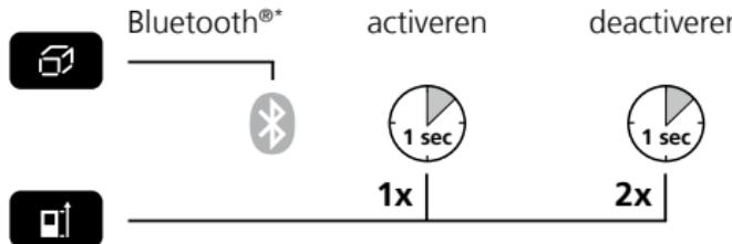
Na de activering verschijnt het Bluetooth®\*-symbool op het display (g). Bij een actieve functie kan een mobiel eindtoestel door middel van een app met het meettoestel worden verbonden.
