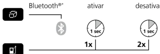
O símbolo Bluetooth®\* aparece no visor (g) após a ativação. Com a função ativada é possível conectar um terminal móvel ao aparelho de medição através de uma App.
