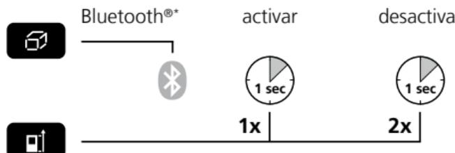
Después de su activación, el símbolo Bluetooth®\* aparecerá en pantalla (g). Cuando la función está activa, cualquier dispositivo móvil se puede conectar al instrumento de medición por medio de la aplicación.
