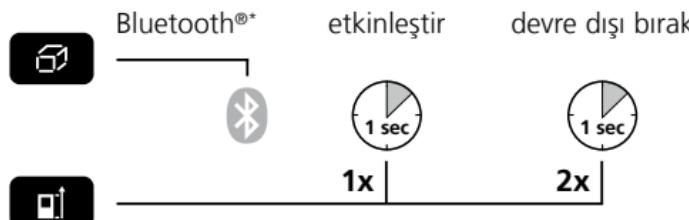
Bluetooth®\* simgesi, etkinleştirildikten sonra ekran da belirir (g). Fonksiyon etkin olduğunda mobil bir cihaz bir App vasıtasyyla ölçüm cihazı ile bağlantı kurabilir.
