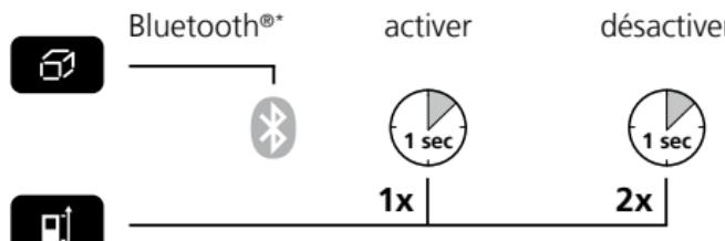
Le symbole Bluetooth®\* apparaît après activation à l'écran (g). Si la fonction est active, un appareil mobile peut se connecter à l'appareil de mesure par l'intermédiaire d'une application.
