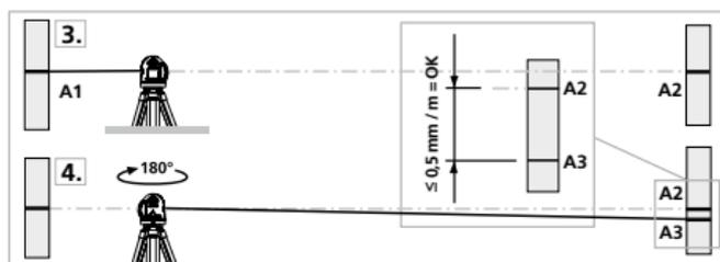
Jos A2 ja A3 ovat toisistaan etäämmällä kuin  $0,5 \text{ mm / m}$ , on säätö tarpeen. Ota yhteys paikalliseen laitetoimittajaan tai UMAREX-LASERLINER huolto-osastoon.
