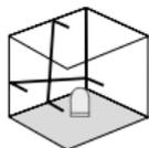
Transportsikringen skal ikke løsnes, skyv skyvebryteren (3) mot høyre. Laseren slås på med PÅ/AV-knappen. Nå kan instrumentet legges på skjeve flater. I denne modus kan det ikke nivelleres horisontalt eller vertikalt, da laserlinjene ikke innretter seg automatisk mer. LED-en (1) og laserlinjene blinker rødt.
