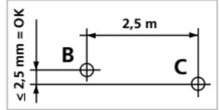
Vérifiez si la ligne horizontale du point C se trouve à  $\pm 2,5$  mm à la même hauteur que le point B. Répétez l'opération en faisant pivoter vers la gauche.
