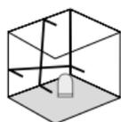
Ne pas dégager le blocage de transport, faire glisser l'interrupteur à coulisse (3) vers la droite. Il est maintenant possible de travailler sur des plans inclinés. Il n'est pas possible d'effectuer un nivellement horizontal ou vertical dans ce mode étant donné que les lignes laser ne s'orientent plus automatiquement. La LED (1) et les lignes laser clignotent en rouge.
