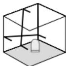
Deactiveer de transportbeveiliging niet en zet de schuifschakelaar (3) naar rechts. Nu kunnen schuine vlakken worden aangelegd. In deze modus kunt u niet horizontaal resp. verticaal nivelleren omdat de laserlijnen niet meer automatisch uitlijnen. De led (1) en de laserlijnen knipperen rood.
