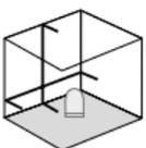
Solte o bloqueador de transporte, deslize o interruptor de correção (3) para a esquerda. A cruz do laser aparece.
