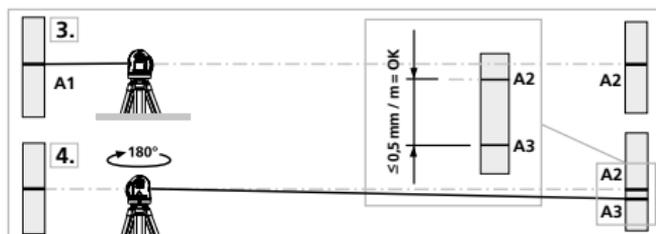
! Wanneer het verschil tussen punt A2 en A3 groter is dan de aangegeven tolerantie, nl. 0,5 mm / m, is een kalibratie nodig. Neem hiervoor contact op met uw vakhandelaar of met de serviceafdeling van UMAREX-LASERLINER.
