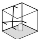
Non allentare la sicurezza di trasporto, spostare l'interruttore a scorrimento (3) verso destra. È ora possibile tracciare piani inclinati. In questa modalità non si può livellare orizzontalmente o verticalmente, in quanto le linee laser non si orientano più automaticamente. Il LED (1) e le linee laser lampeggiano in rosso.
