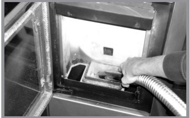
2. Entnehmen Sie dann den Brenntopf. Überprüfen Sie die Luftöffnungen am Boden des Brenntopfes. Vergewissern Sie sich, dass alle Luftöffnungen weder verstopft noch zugesetzt sind. Saugen Sie den Brenntopf gründlich ab (siehe Abb. 12b). Entfernen Sie hartnäckige Verkrustungen und Blockaden, wenn nötig, mit einem geeigneten Werkzeug (siehe Abb. 12c).
