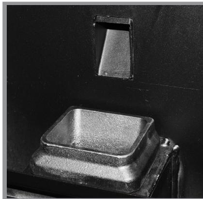
Abb. 6b: Richtig eingesetzter Brenntopf
