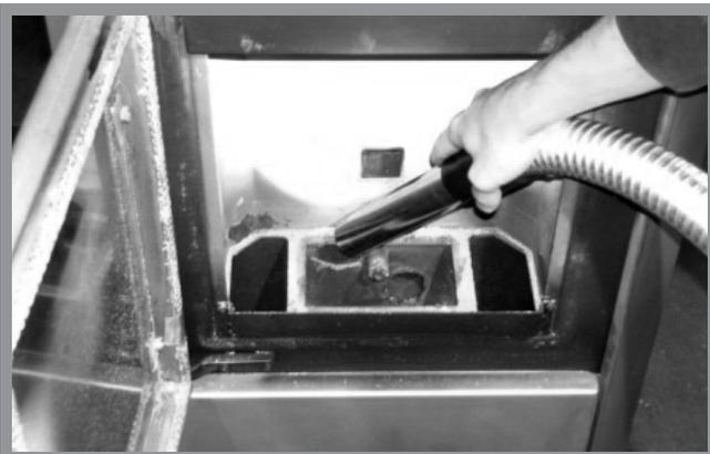
Abb. 12d: Reinigung der Topfhalterung
