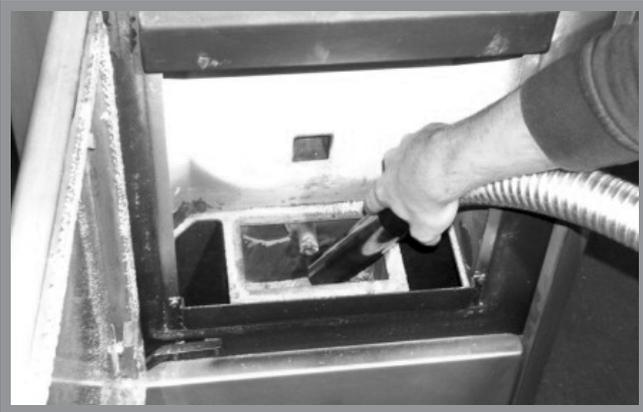
Abb. 12f: Reinigung Brennraumbehälter
