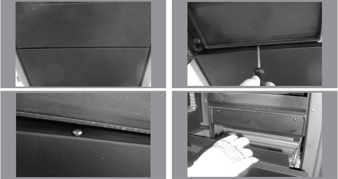
Abb. 13a: Öffnen der Frontplatte
