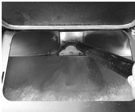
Fig. 23 - Reinigung Tank und Schnecke
