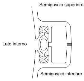
Per collegare i due semigusci montare i raccordi rapidi prima verso destra e poi verso sinistra. Durante questa prima fase uno ogni due raccordi viene regolato a mano e quindi fissato con un martello e un listello di legno. Per facilitare il montaggio i raccordi dovrebbero essere ingrassati sugli spigoli interni. I raccordi si incastrano nella posizione finale.
