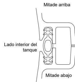
Para fijar las dos partes fije un conector en forma de clip de manera intercalada a la derecha y a la izquierda. Para ello ajuste primero cada segundo conector con la mano y en seguida con un martillo y una base de madera. Para facilitar el montaje, engrase los conectores en los bordes interiores. Encage los conectores en la posición definitiva.
