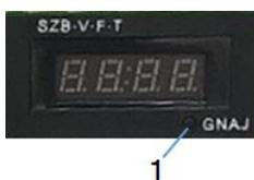
Durch Betätigung der Taste (1) kann zwischen den einzelnen Modi gewechselt werden:
