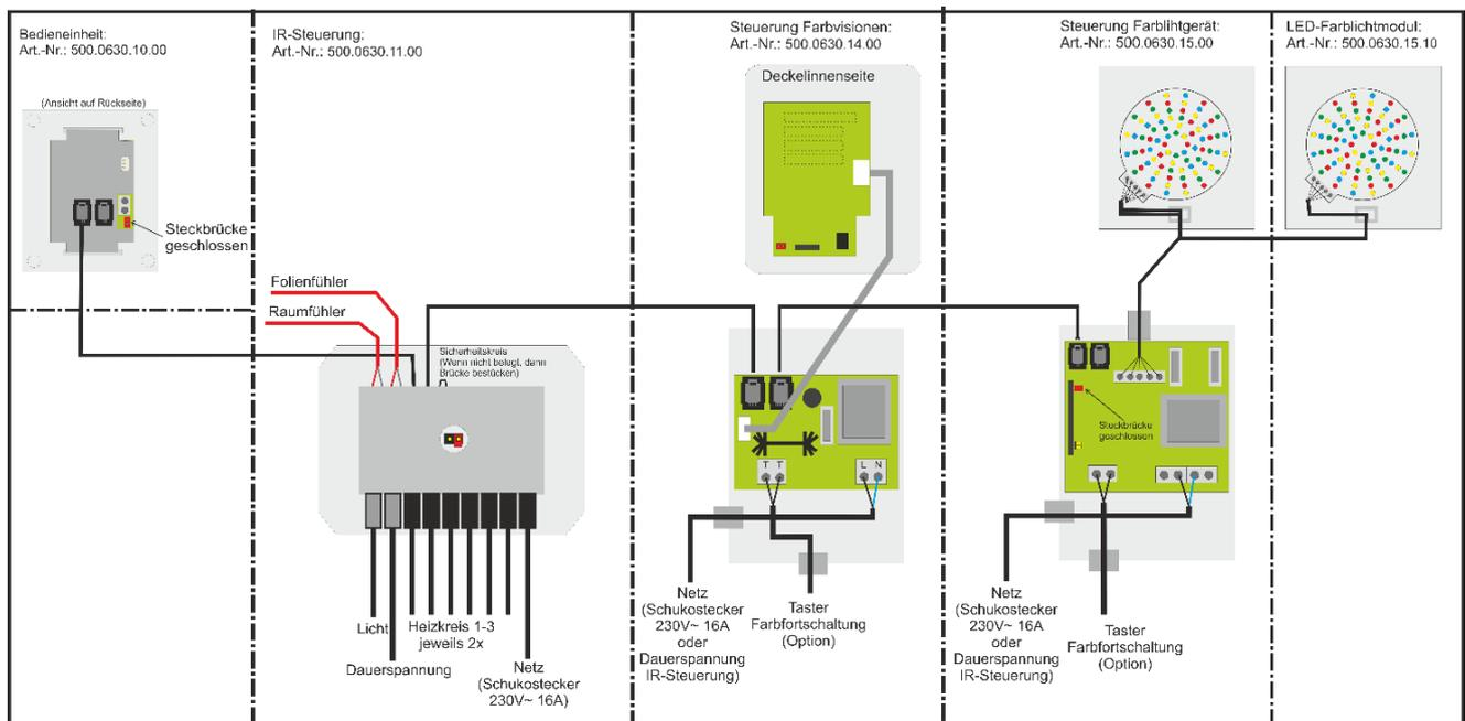
Abbildung 2 Anschlussbeispiel IR-Steuerung
