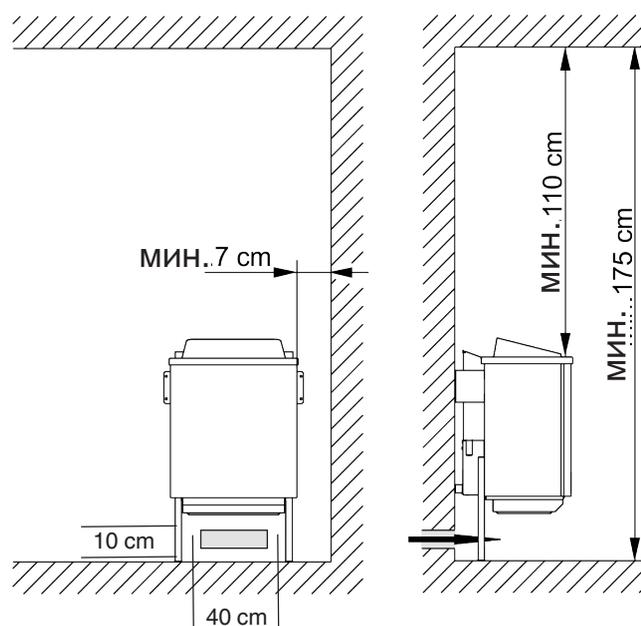
нагревателя и потолком сауны составляло минимум 110 см, а расстояние по горизонтали (сбоку) между нагревателем и стеной кабины было не менее 7 см. Расстояние между нижним краем нагревателя и полом задано конструкцией устройств (регулируемая ножка). Расстояние между задней стенкой нагревателя и стеной кабины также задано конструкцией (кронштейн для крепления на стене).
