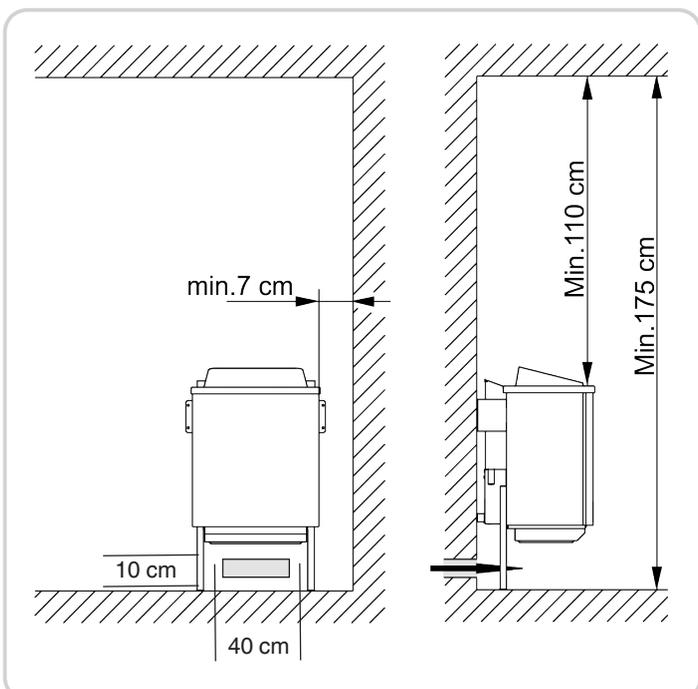
naofen und Saunadecke mindestens 110 cm beträgt, der waagerechte (seitliche) Abstand zwischen Ofen und Kabinenwand mindestens 7 cm beträgt. Der Abstand zwischen Ofenunterkante und Fußboden ist durch die Bauart der Geräte (Stellfuß) vorgegeben. Der Abstand zwischen Ofenrückwand und Kabinenwand ist ebenfalls durch die Bauart (Wandhalterung) vorgegeben.
