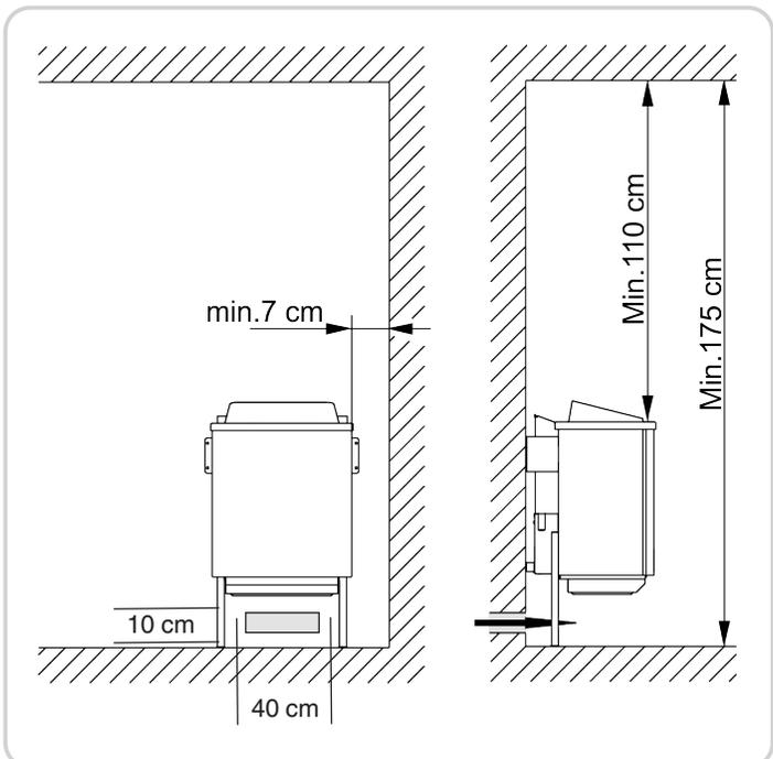
boku) pomiędzy piecem i ścianą kabiny co najmniej 7 cm. Odległość pomiędzy dolną krawędzią pieca i podłogą jest określona przez typ konstrukcji urządzenia (nóżka). Odległość pomiędzy tylną ścianą pieca i ścianą kabiny jest określona przez typ konstrukcji urządzenia (wspornik naścienny).
