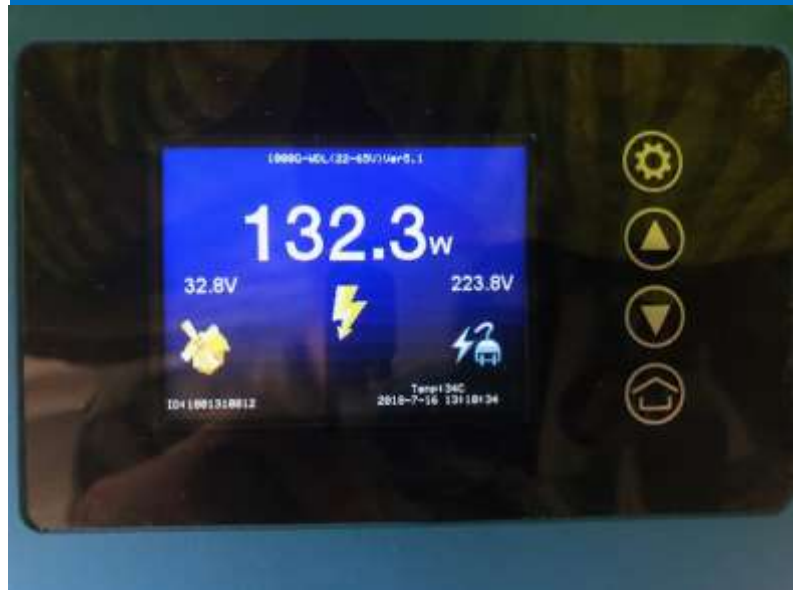
Betriebsdatenanzeige des SkyWind Wechselrichters
