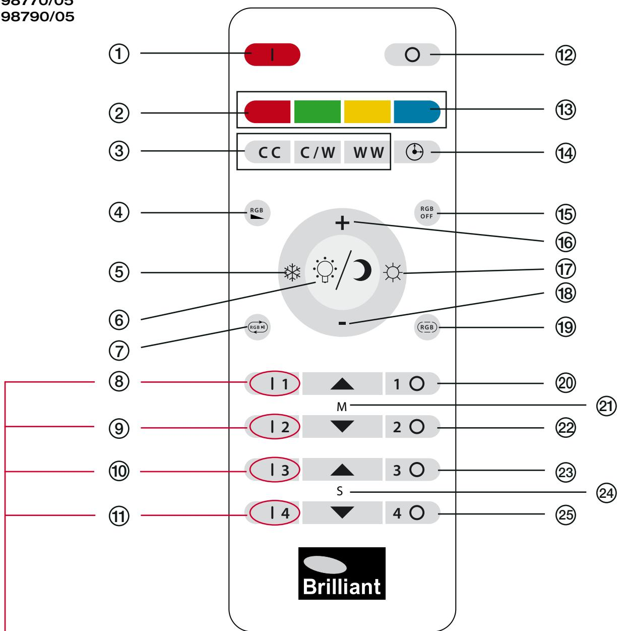
**DE** **Schnellstart:** Halten Sie eine dieser Tasten gedrückt, während Sie die Lampe zum ersten Mal einschalten, um die Fernbedienung mit der Lampe zu verbinden.
