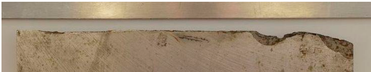
Ausbruch an der Schneide
