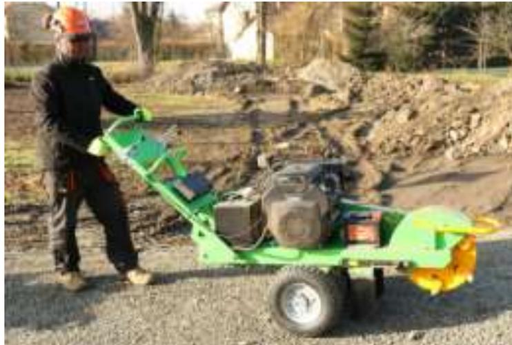
Zur Bedienung muss der Bedienende hinter dem Holm stehen (siehe Abbildung). Er muss den Betätigungsholm mit beiden Händen halten und einen festen Stand haben.
