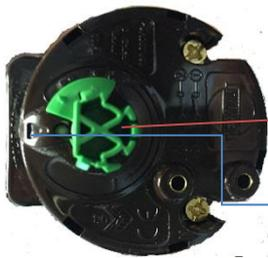
**Regulierungsthermostat:** Durch das Drehen des grünen Reglers wird die Temperatur im Speicher eingestellt (0 Grad=keine Heizleistung bis MAX); Bei aktiver Heizung kann die Wassertemperatur zwischen 20 Grad Celsius und 75 Grad Celsius eingestellt werden;
