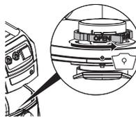
De rode draaischijf (binnenin de aanzuigopening) tot aan de aanslag draaien: de tekst "OPEN" is naar boven naar de markering ▲ gericht.
