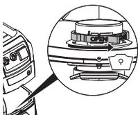
Otočte červeným otočným voličem (na vnitřní straně sacího otvoru) do koncové polohy: nápis „OPEN“ (OTEVŘENO) směřuje nahoru ke značce ▲.
