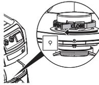
De rode draaischijf (binnenin de aanzuigopening) tot aan de aanslag draaien: de tekst "CLOSE" is naar boven naar de markering ▲ gericht.
