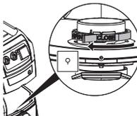
Завъртете червения въртящ се превключвател (от вътрешната страна на отвора за засмукване) до ограничителя: текстът „CLOSE“ („ЗАТВОРЕНО“) сочи нагоре към маркировката ▲.
