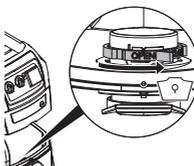
Tourner la vanne rotative rouge (dans l'intérieur de l'orifice d'aspiration) jusqu'à la butée : le texte « OUVERTURE » pointe vers le haut et vers le repère ▲.
