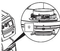
Okrenite crveni rotacijski prekidač (na unutarnjoj strani usisnog otvora) do graničnika: tekst "CLOSE" prikazuje se prema gore do oznake ▲.
