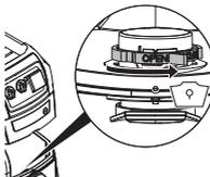
Rodar o botão rotativo vermelho (no interior da abertura de aspiração) até ao encosto: o texto "OPEN" fica voltado para cima em direção à marcação ▲.
