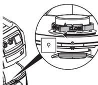
Obrócić do oporu czerwoną zasuwkę (wewnątrz otworu ssawnego): tekst „CLOSE” jest skierowany do góry, w stronę znaku ▲.
