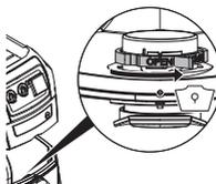
Obrócić do oporu czerwoną zasuwkę (wewnątrz otworu ssawnego): tekst „OPEN” jest skierowany do góry, w stronę znaku ▲.
