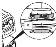
Gire el disco giratorio rojo (en el interior del orificios de aspiración) hasta el tope: el texto "CLOSE" mira hacia arriba hacia la marca ▲.
