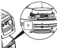
Tourner la vanne rotative rouge (dans l'intérieur de l'orifice d'aspiration) jusqu'à la butée : le texte « FERMETURE » pointe vers le haut et vers le repère ▲.
