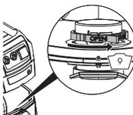
Rotiți ghidajul rotativ roșu (de pe partea interioară a orificiului de aspirare) până la capăt: textul „OPEN” (DESCHIS) apare deasupra marcajului ▲.
