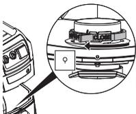
Otočte červeným otočným voličem (na vnitřní straně sacího otvoru) do koncové polohy: nápis „CLOSE“ (ZAVŘENO) směřuje nahoru ke značce ▲.
