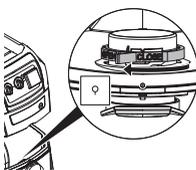
Otočte červený otočný prepínač (na vnútornej strane sacieho otvoru) až na doraz: text „CLOSE“ (zatvorený) ukazuje smerom nahor na označenie ▲.
