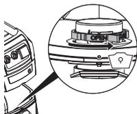
Завъртете червения въртящ се превключвател (от вътрешната страна на отвора за засмукване) до ограничителя: текстът „OPEN“ („ОТВОРЕНО“) сочи нагоре към маркировката ▲.
