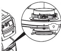
Okrenite crveni rotacioni prekidač (na unutrašnjosti otvora za usisavanje) na zaustavljanje: tekst „OTVORENO“ pokazuje na gore ka oznaci ▲.
