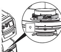
Ruotare il raccordo rotante rosso (collocato all'interno dell'apertura di aspirazione) fino alla battuta: la scritta "CLOSE" è rivolta in alto verso il simbolo ▲.
