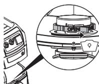
Gire el disco giratorio rojo (en el interior del orificios de aspiración) hasta el tope: el texto "OPEN" mira hacia arriba hacia la marca ▲.
