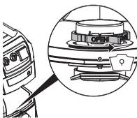
Otočte červený otočný prepínač (na vnútornej strane sacieho otvoru) na doraz: text „OPEN“ (otvorený) ukazuje smerom nahor na označenie ▲.
