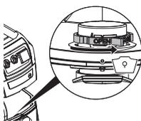
Okrenite crveni rotacijski prekidač (na unutarnjoj strani usisnog otvora) do graničnika: tekst "OPEN" prikazuje se prema gore do oznake ▲.
