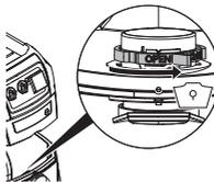
Ruotare il raccordo rotante rosso (collocato all'interno dell'apertura di aspirazione) fino alla battuta: la scritta "OPEN" è rivolta in alto verso il simbolo ▲.
