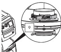
Okrenite crveni rotacioni prekidač (na unutrašnjosti otvora za usisavanje) dok se ne zaustavi: tekst „ZATVORENO“ pokazuje na gore ka oznaci ▲.
