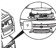
Rodar o botão rotativo vermelho (no interior da abertura de aspiração) até ao encosto: o texto "CLOSE" fica voltado para cima em direção à marcação ▲.
