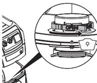
Den roten Drehschieber (im Innern der Ansaugöffnung) bis zum Anschlag verdrehen: der Text „OPEN“ zeigt nach oben zur Markierung ▲.
