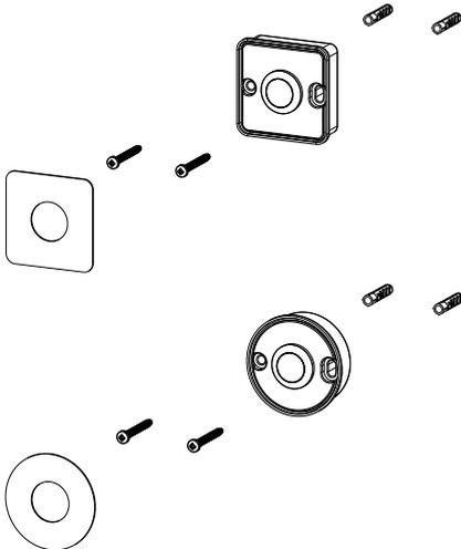
Den Aufputzadapter am Mauerwerk ausrichten und mit dem mitgelieferten Befestigungsmaterial befestigen. Align the surface-mounted adapter on the masonry and fasten it with the supplied fastening material.
