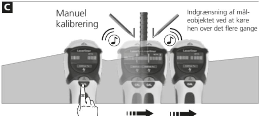
Tip 1: Mellem de to markeringer er midten af metalobjektet. På grund af den høje måle følsomhed kan tykke metalobjekters målte bredde virke bredere end den reelle bredde. Bevæg da efter apparatet hen over det fundne måleobjekt; se figur B. Herved kalibreres apparatet automatisk. Den manuelle kalibrering bør ske i nærheden af det sidst fundne sted; se figur C. Denne fremgangsmåde gentages efter behov.
