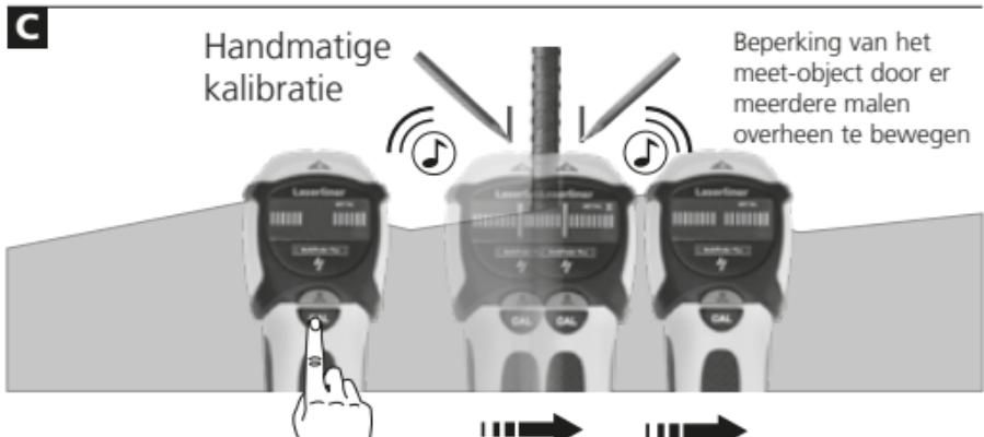
**Tip 1:** Tussen beide markeringen in ligt het midden van het metalen object. Door de hoge meetgevoeligheid verschijnen dikke metaalobjecten breder dan deze in werkelijkheid zijn. Beweeg het apparaat daarom opnieuw over het gevonden meetobject, zie grafiek B. Het apparaat kalibreert hierbij automatisch. De handmatige kalibratie dient in de buurt van de als laatste gevonden positie te worden uitgevoerd, zie grafiek C. Herhaal deze werkstappen zo nodig.
