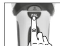
Die maximale Geräteempfindlichkeit wird erreicht, wenn das Gerät bei der Kalibrierung in die Luft gehalten wird. Dies kann bei METAL- und AC-SCAN-Messungen stellenweise sinnvoll sein.
