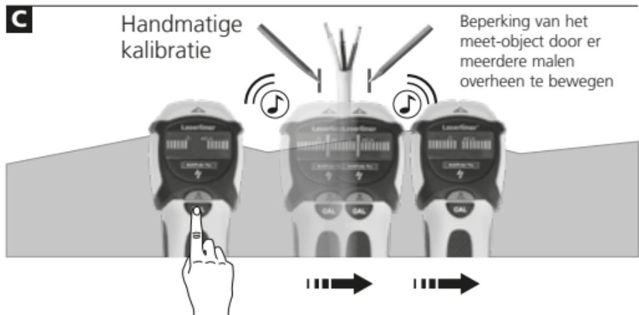
Tip 1: De handmatige kalibratie dient in de buurt van de als laatste gevonden positie te worden uitgevoerd, zie grafiek B/C. Herhaal deze werkstappen zo nodig.
