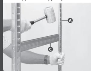
**11** Zopakujte krok č. 5 pro vytvoření dalších tří podlaží ve tvaru („H“) a pokračujte v propojení těchto tří podlaží („H“) tvaru se stojinami ve stejné výšce, jako jsou umístěny krátké nosníky **C**.
