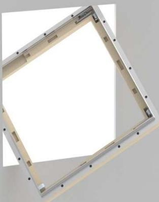
Türblatt aushängen, Rahmen diagonal durch den Ausschnitt führen und von hinten einsetzen.
