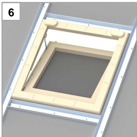
Wechselrahmen nach Abbildung anfertigen.
