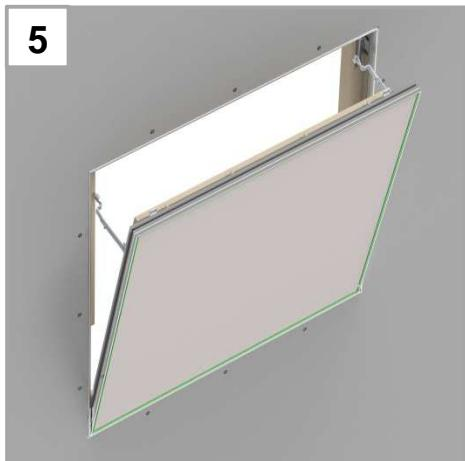
Klappe einhängen, sichern und verschließen.
