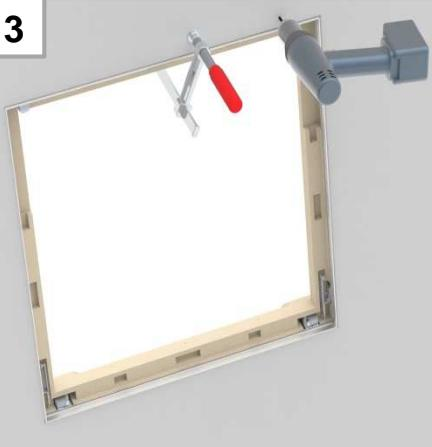
Rahmen ausrichten (Rechtwinkligkeit prüfen), festspannen und Bohrungen anzeichnen, Bohrabstand ≤ 250 mm.
