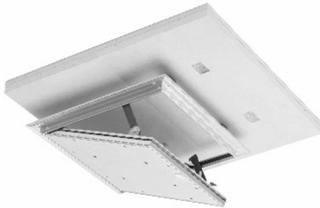
Die Revisionsöffnungsverschlüsse sind geprüfte Brandschutzprodukte mit einer Allgemeinen bauaufsichtlichen Zulassung und Bauartgenehmigung für die BRD. Die Feuerwiderstandsdauer von 30 Minuten wurde brandschutztechnisch nachgewiesen. Die Produkte eignen sich je nach Zulassung für den Einbau in abgehängte und freitragende Brandschutzunterdecken im Trockenbau.
