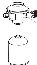
**Druckregler DIN EN 16129 für den Anschluss an die Schraubkartusche.**
