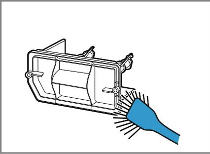
Stellen Sie sicher, alle Verunreinigungen von der Dichtung zu entfernen.
