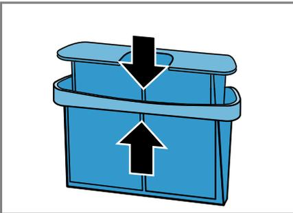
10. Das zweiteilige Flusensieb einsetzen.
