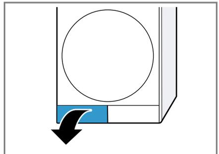
Wenn Sie ein Tuch unter die Wartungsklappe legen, können Sie das Restwasser der Bodeneinheit auffangen.
