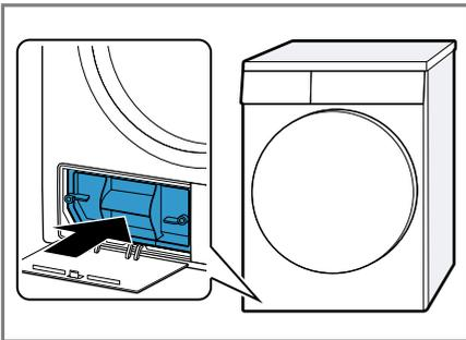
2. Die Hebel der Wärmetauscherabdeckung schließen.
