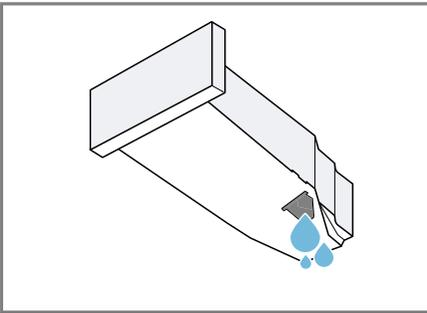
Stellen Sie sicher, den Kondenswasserbehälter vor dem Betrieb des Geräts einzuschieben.
