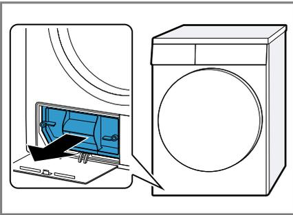
2. Die Wärmetauscherabdeckung mit einer weichen Bürste reinigen.
