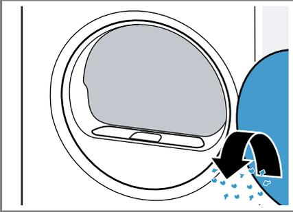
3. Das zweiteilige Flusensieb entfernen.
