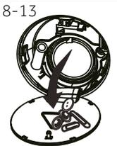
7. Lösen Sie den Pumpenfilter durch Drehen gegen den Uhrzeigersinn, nehmen Sie den Pumpenfilter heraus (Abbildung 8-12).
