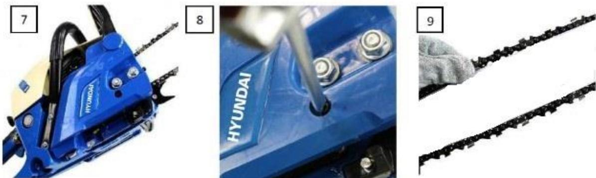
9. Ziehen Sie die Kettenabdeckungsmuttern mit einem Drehmomentschlüssel an (12 – 15Nm). Überprüfen Sie, ob die Kette auf der Schiene leicht läuft, indem Sie diese von Hand bewegen. Bei Bedarf die Kettenabdeckung wieder lösen und Spannung nachstellen.
