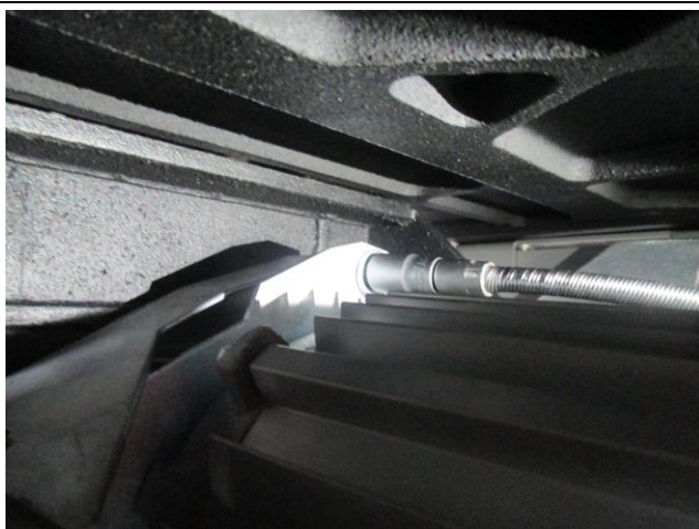
ACHTUNG: Schraube oben vorsichtig lockern und Motor festhalten !
