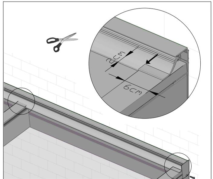
Das Dichtgummi in die Wandpfette einziehen. Im Anschluss schneiden Sie die Gummidichtung unmittelbar an den Aluminiumprofilen soweit ein (ca.2cm) bis die Gummilippe auf der Platte aufliegt.
