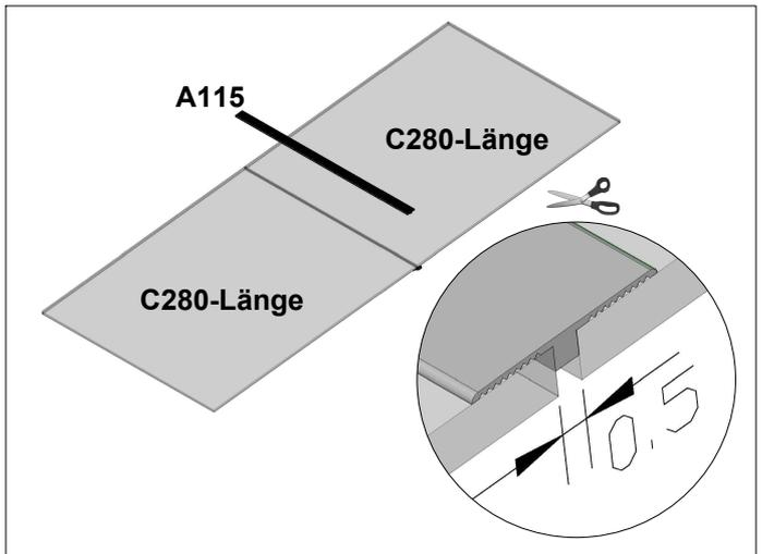
Dichtgummi in die Aluprofile einziehen und die Aluprofile mit einem 5mm Metallbohrer in einem gleichmäßigen Abstand für die Schrauben C104-0045 vorbohren. Schneiden Sie nun das Dichtprofil A115 auf Länge (Breite der Glasplatten) und justieren Sie die sauberen, trockenen und fettfreien Glasplatten mit einem durch das Silikondichtprofil vorgegebenen Abstand von 5mm auf Hohlprofil und Sparren. Arbeiten Sie die Sparrenabstände von einer Seite zur anderen ab.
