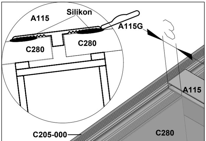
**Tipp:** Das Ergebnis der Verklebung des Profils ist später von der Terrasse aus sichtbar, testen Sie den Umgang mit einem Silikonspachtel vorher an eine nicht sichtbaren Stelle.
