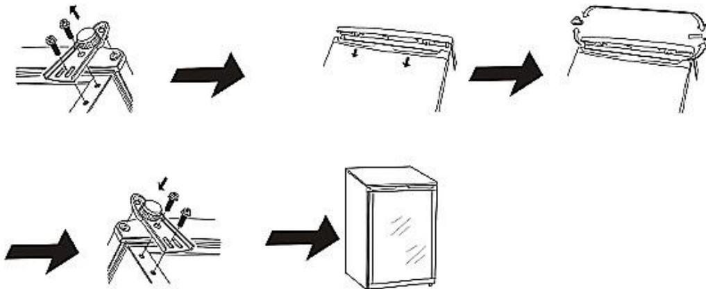
1. Entfernen Sie die Schrauben und die Scharnierklammer an der Unterseite.
