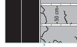
POSE SUR TASSEAU - INSTALLING ON JOISTS - INSTALACIÓN SOBRE CALZOS - ANBRINGEN AUF LATTTUNG - OP LATSEN - POSA SU TASSELLI - COLOCAÇÃO SOBRE RIPAS
