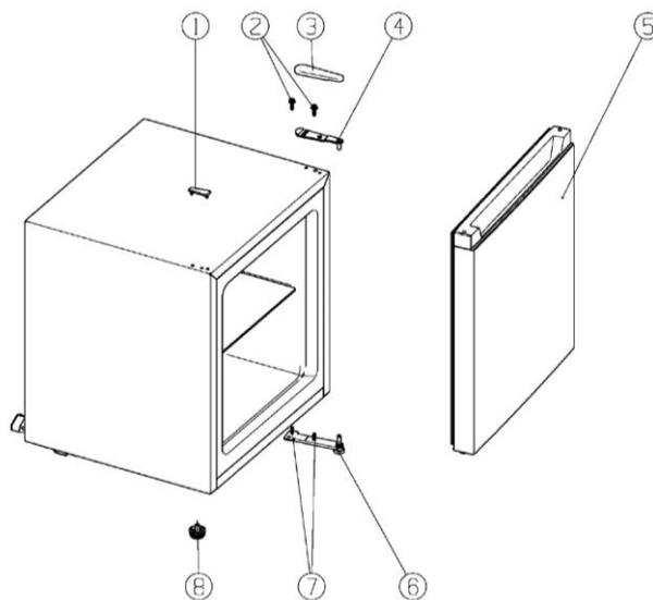
1. Entfernen Sie die Abdeckung (3) der des Türscharniers mit Hilfe eines kleinen Schlitzschraubendrehers und lösen Sie die 2 Schrauben (2) um das obere Türscharnier (4) abzuschrauben.
