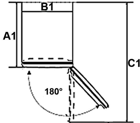
$A\ 1 = \text{TIEFE} / B\ 1 = \text{BREITE} / C\ 1 = \text{TIEFE (BEI GEÖFFNETER TÜR)}$
