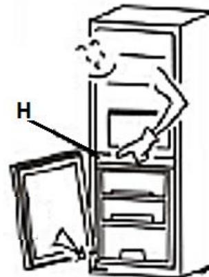
7. Platzieren Sie die Kühlschranktür auf dem mittleren Scharnier; der Scharnierstift muss sich in der Öffnung unten an der Kühlschranktür befinden. Türe schließen; danach bringen Sie das obere Scharnier an der gegenüberliegenden Seite an. Der obere Scharnierstift muss sich in der Öffnung oben an der Kühlschranktür befinden. Bringen Sie die Scharnierabdeckung wieder an.
