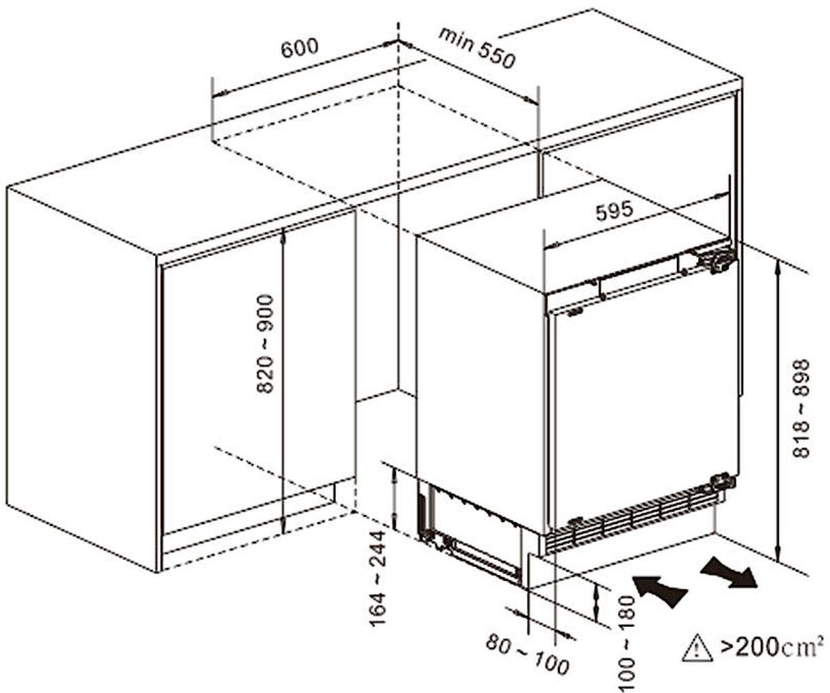
ERFORDERLICHE BELÜFTUNGSÖFFNUNG =  $>200\text{ cm}^2$
