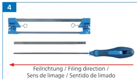
Zum Feilen der linken Zähne müssen beide Feilen im Halter um 180° umgelegt werden (Abb. 4). Es ist darauf zu achten, dass der Pfeil auf der Tiefenbegrenzerfeile in Feilrichtung zeigt (Abb. 5).
