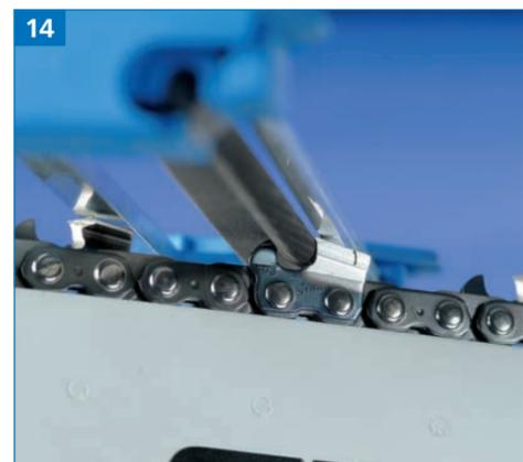
CHAIN SHARP schärft die Zähne und feilt die Tiefenbegrenzer in einem Arbeitsgang (Abb. 14).
