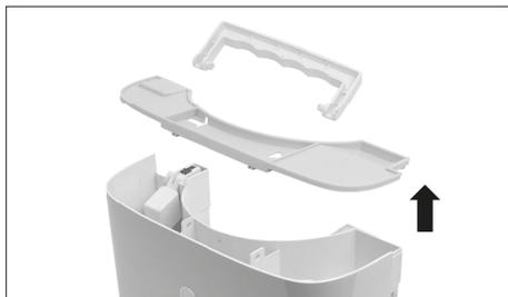
Demontați rezervorul de apă pentru curățare și remontați-l în sens invers înainte de a-l reinstala în aparat.
