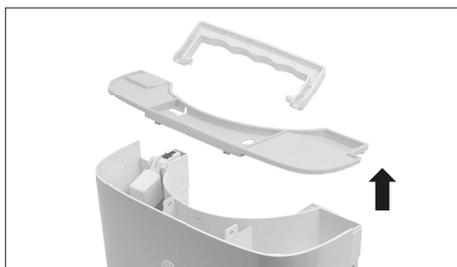
Vyjměte vodní nádrž k vyčištění a znovu ji namontujte zpět v opačném pořadí, v jakém jste ji vytahovali.
