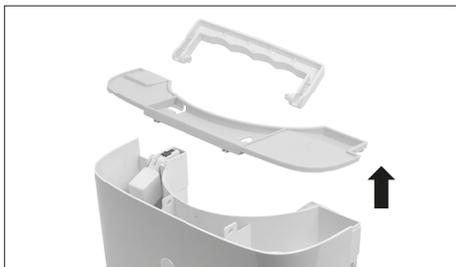
Demontera vattentanken för rengöring och montera samman den i omvänd ordningsföljd innan den sätts tillbaka i apparaten.
