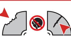
Keine beschädigte Schleifscheibe verwenden
