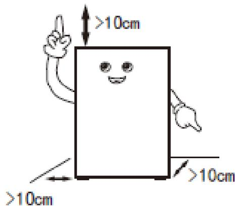
Um eine optimale Effizienz des Gerätes zu ermöglichen, empfiehlt der Hersteller folgende Mindestabstände.
