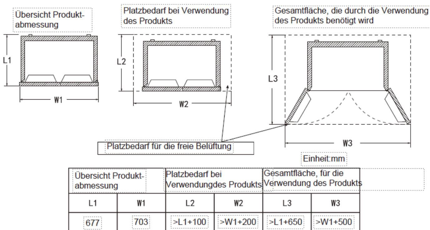
**HINWEIS!** Jegliche Schäden am Gerät, die durch eine nicht ordnungsgemäße Belüftung entstehen, unterliegen weder der Garantie noch der Gewährleistung!
