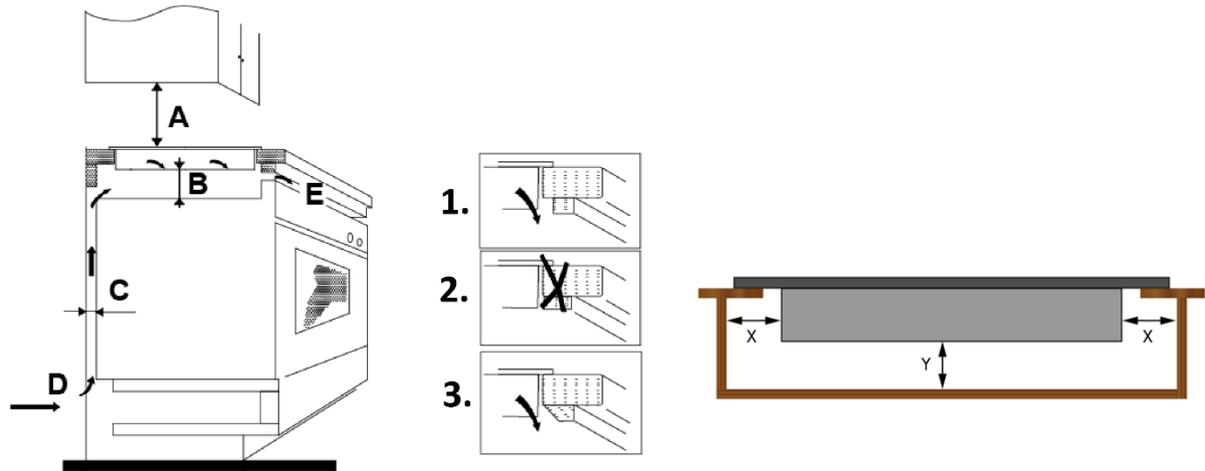
**D = BELÜFTUNGSSCHLITZ / E = LUFT AUSLASS**
