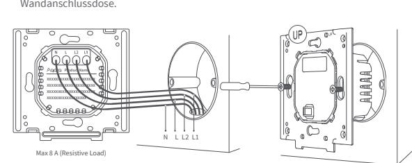
6. Stellen Sie sicher, dass die Schrauben an der Unterseite des Geräts gelöst sind. Hängen Sie dann die Oberseite des Geräts an die Schaltersockel. Achten Sie darauf, dass das Panel korrekt mit der Wand absieht und korrekt mit dem Schaltersockel ausgerichtet ist. Achten Sie auf die Position der Schnittstellen. \*Achten Sie darauf, beim Lösen der Schrauben an der Unterseite der Hafnung keine zu große Kraft anzuwenden, um eine Beschädigung der Schrauben zu verhindern.
