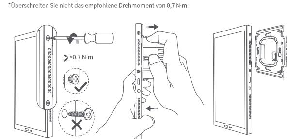
5. Befestigen Sie die Schaltersockel mit den mitgelieferten Schrauben an der Wandanschlussdose.
