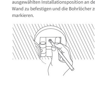
2. Verwenden Sie einen 80-mm Bohrer, um Löcher entsprechend den markierten Positionen zu bohren, wobei die Tiefe  $\geq 32$  mm.
