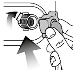
**HINWEIS!** Ziehen Sie den Wasserzulaufschlauch nicht zu stark an. Dadurch könnten die Ventile beschädigt werden.
