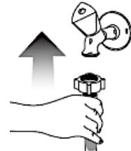
3. Legen Sie das andere Ende des Wasserzulaufschlauchs in einen Eimer oder in ein anderes geeignetes Gefäß (s. Abb. rechts) und öffnen Sie den Wasserhahn, um Fremdstoffe (z.B. Schmutz, Sand etc.) aus der Wasserleitung und dem Schlauch zu spülen. Kontrollieren Sie die Wassertemperatur.
