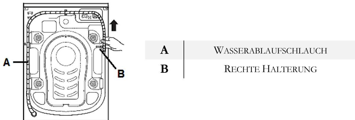
**HINWEIS!** Wenn das Gerät außer Betrieb ist, befestigen Sie den Wasserablaufschauch (A) mit der entsprechenden Halterung (B) an der Rückseite des Gerätes (s. Abb. oben. **Entfernen Sie die Halterung nicht!**).
