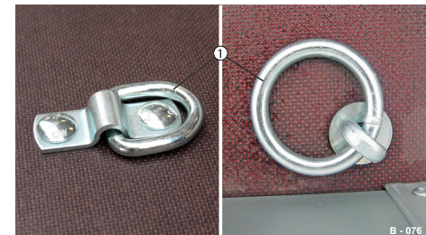
Abb. 60 Zurrpunkte aufliegend, optional (Zurrkraft = max. 200 daN (kg))
