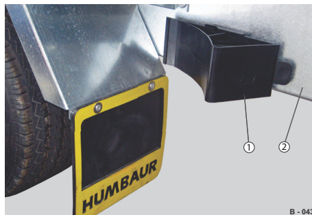
Abb. 78 Beispiel 2: Unterlegkeile waagrecht, seitlich
