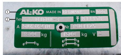
Abb. 25 Beispiel: Typenschild AL-KO-Achse, gebremst
