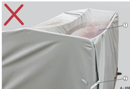
Abb. 66 Beispiel: Wasserlast auf Hochplane
