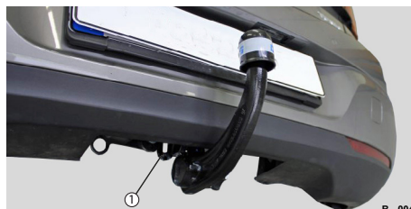
Abb. 3 Beispiel 3, abnehmbare Kupplung, Öse am Träger
