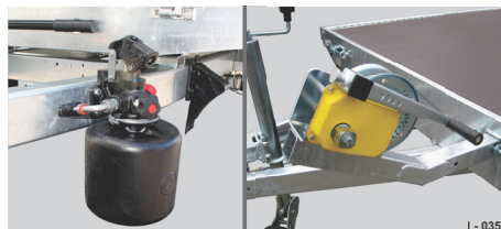
Abb. 44 Hydraulikanlage manuell, elektrisch / Seilwinde
