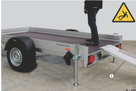
Abb. 31 Ladefläche über Auffahrhilfen betreten
