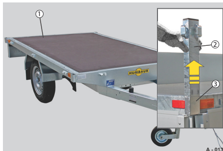
Abb. 14 Bordwände demontiert, Eckrunge ausgesteckt
