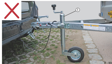
Abb. 7 Stützrad, Stützstellung falsch
