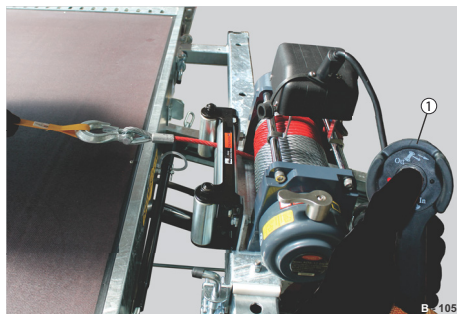
Abb. 46 Beispiel 2: Seilwinde mit Fernbedienung
