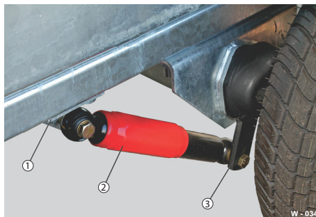
Abb. 38 Radstoßdämpfer eingebaut, Variante 2
