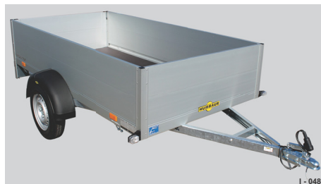
Abb. 3 Beispiel: Offener Kasten, ungebremst, bis 750 kg
