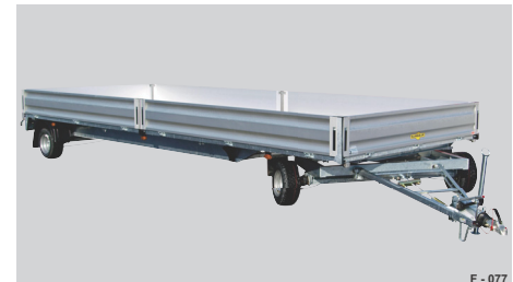
Abb. 55 Beispiel: 2-Achser als Kastenaufbau
