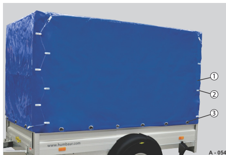
Abb. 61 Sicherung mit Schleuderseil / Krampen
