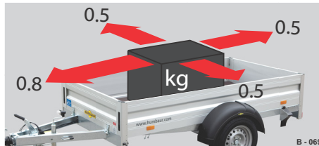
Abb. 55 Zu sichernde Kräfte gegen Rutschen
