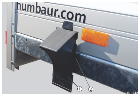
Abb. 77 Beispiel 1: Unterlegkeile senkrecht, seitlich
