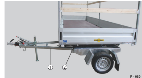
Abb. 54 Drehschemelfunktion, mit Spriegelgestell
