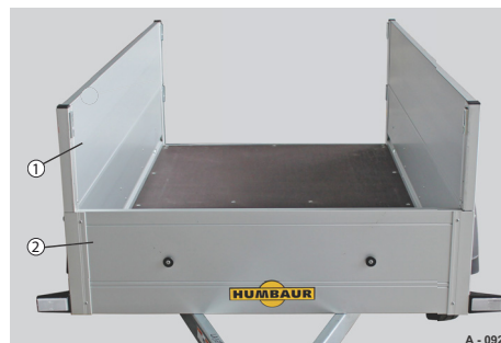
Abb. 26 Heckbordwand / Bordwandaufsatz, demontiert
