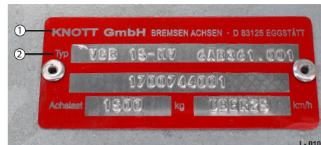
Abb. 24 Beispiel: Typenschild KNOTT-Achse, ungebremst
