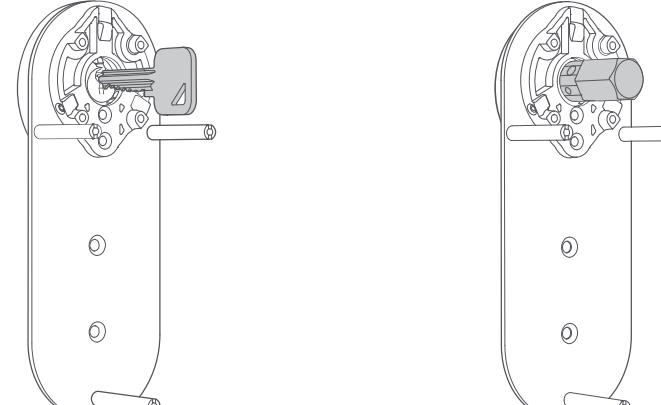
Öffnen Sie die Batterieabdeckung und befestigen Sie das Schloss mit Schrauben an der festen Platte. Drehen Sie den Knopf, um ein reibungsfreies Ver- und Entriegeln zu gewährleisten. Passen Sie die Schraubenfestigkeit bei Bedarf an, um Betriebsprobleme zu vermeiden.
