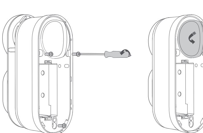
Setzen Sie die Batterien ein, installieren Sie die Batterieabdeckung und schließen Sie die Installation des Schlosses ab. Fahren Sie anschließend mit der Installation des Tastenfelds fort.
