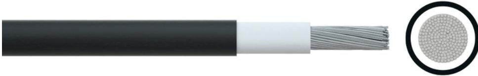
**Verwendung:** Solarleitung für frei beweglichen Einsatz oder feste Verlegung in Photovoltaik-Anlagen nach EN 60364-7-712. Sie dürfen in Innenräumen, im Freien, in explosionsgefährdeten Bereichen, in der Industrie oder in landwirtschaftlichen Betrieben verwendet werden und sind für direkte Verlegung in Erde zugelassen. Die Leitung gilt als kurz- und erdschlussicher. Sie entspricht der VDE-Anwendungsregel VDE-AR-E 2283-4. Zusätzlich werden an der Leitung folgende Prüfungen durchgeführt:
