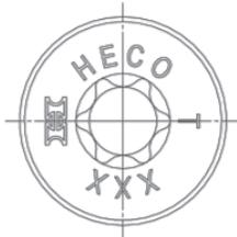
Kopfkennzeichnung bei  $d = 6,0$  bis  $10,0$  der Ausführungen: Flachsenkkopf.
