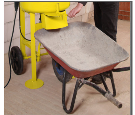
Direktes Entleeren durch die ideale Höhe des Auswurf- schachtes in eine Schubkarre.
