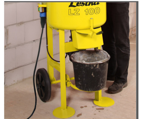
Robuster, klappbarer Kübelhalter zum Entleeren in einen Mörtel- eimer.
