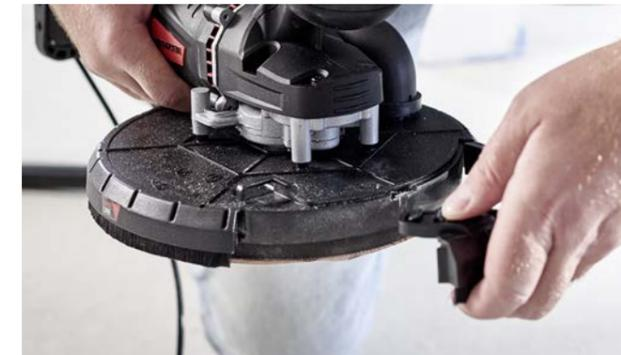
Die Schleifkopfspitze lässt sich mit einem Klick entfernen.
